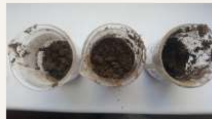
Şekil-23:Toprağa gömülü fitil numuneler
